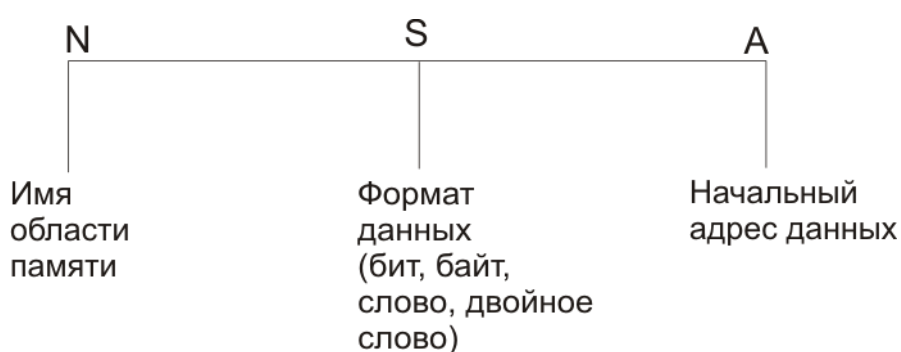
Рис.7.4 Адресация областей памяти для ПЛК S7 – 200 Siemens
