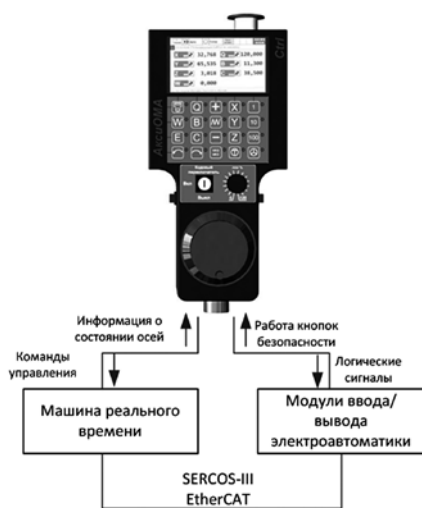
Рис. 2. Схема пульта дистанционного управления с подключениями
