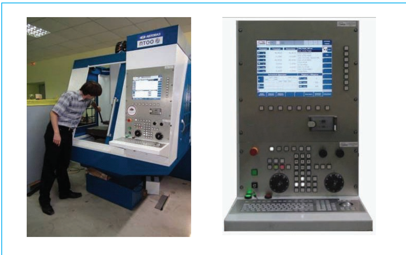
Рис. 7. Система ЧПУ АксиОМА Ctrl на фрезерном обрабатывающем центре MC-400
