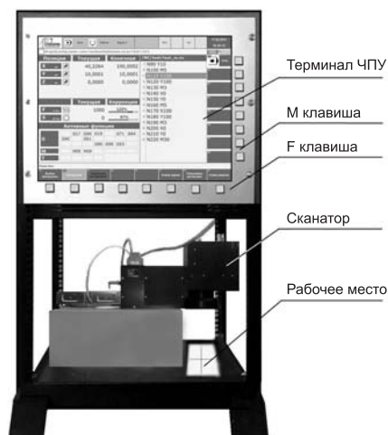
Рис. 5 Стенд для обработки алгоритмов гравировки на основе гальваносканатора
