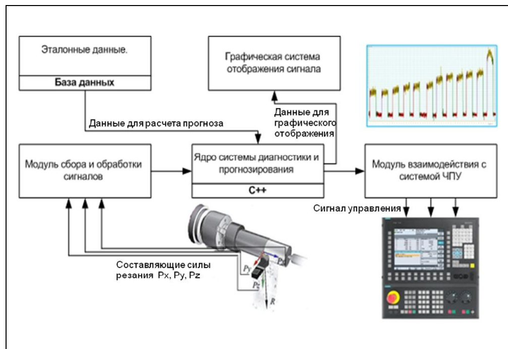
Рис. 1. Архитектурная модель системы диагностики и прогнозирования состояния режущего инструмента в реальном времени
