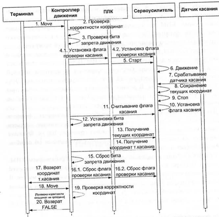
Рис. 3. Алгоритм обработки события о достижении точки касания
