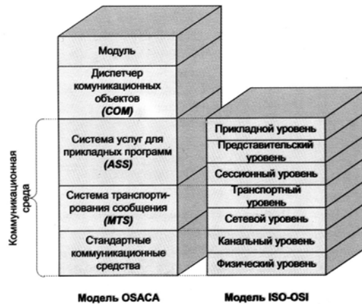
Рис. 4. Сопоставление структур коммуникационной среды PCNC и модели ISO - OSI
